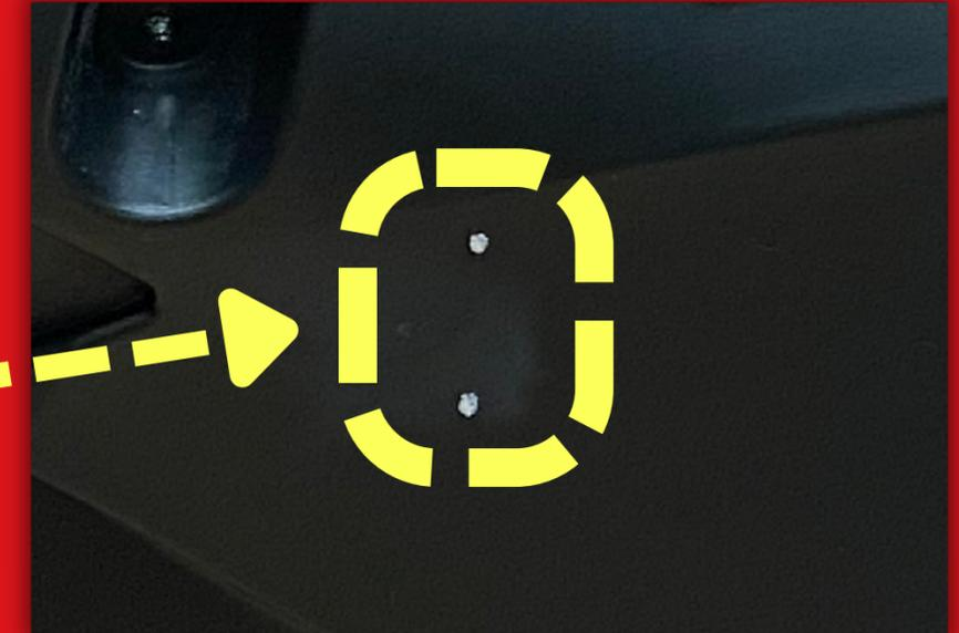
HACER 2 TALADROS PARA LA FIJACIÓN DE LA PINZA DE LA BOTELLA DE EXPANSIÓN DEL AMORTIGUADOR TRASERO.
