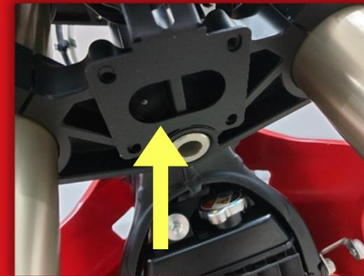
Colocar el faro con el soporte, encajando por debajo de la tija inferior, y **por encima del guardabarros**, según fotografía.
