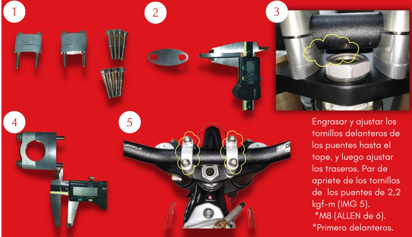
Engrasar y ajustar los tornillos delanteros de los puentes hasta el tope, y luego ajustar los traseros. Par de apriete de los tornillos de los puentes de 2,2 kgf-m (IMG 5).
