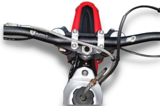
Una vez instalado el manillar, colocar el cable de gas y el latiguillo embrague, según la fotografía.
