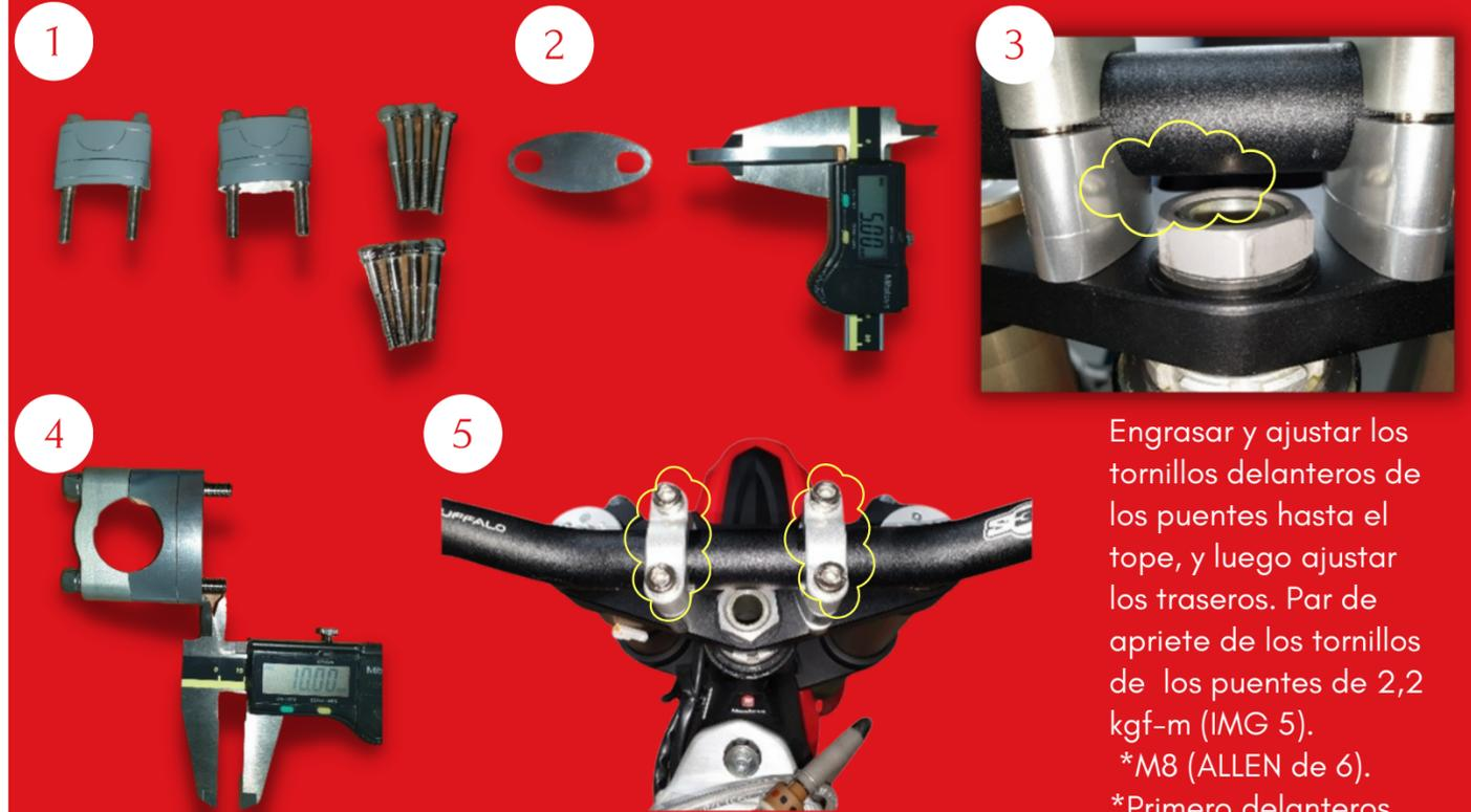
Engrasar y ajustar los tornillos delanteros de los puentes hasta el tope, y luego ajustar los traseros. Par de apriete de los tornillos de los puentes de 2,2 kgf-m (IMG 5).
