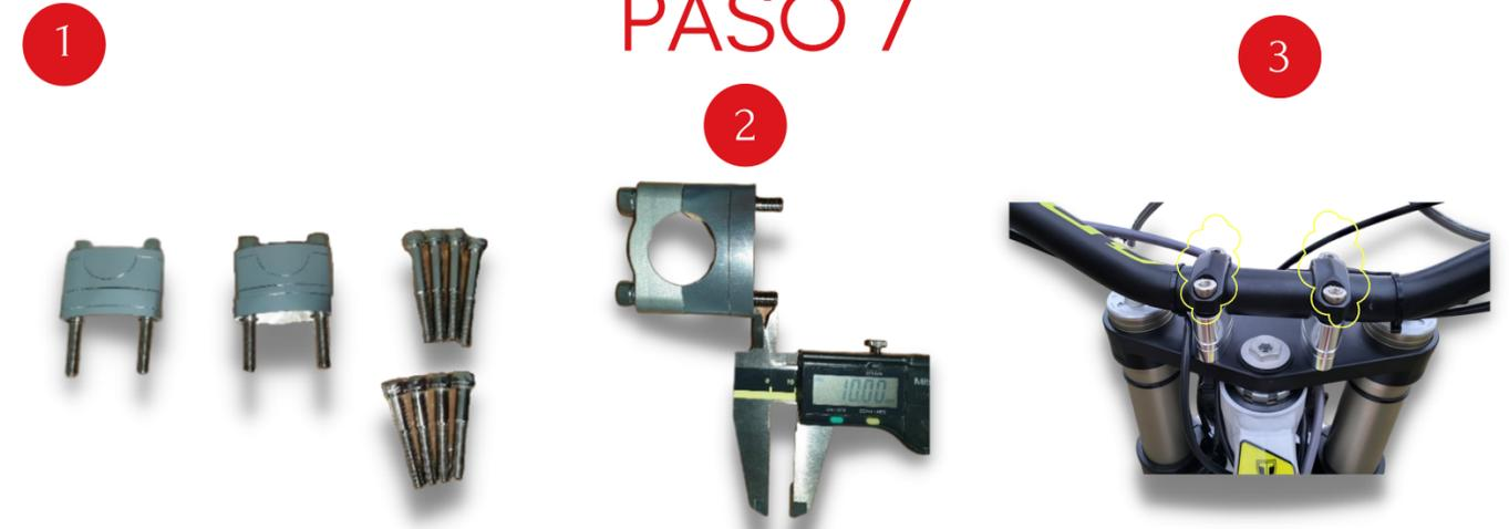
Colocaremos los puentes de manillar suministrados (IMG 1) en la tija superior. Los puentes superiores usaremos los de serie de 28 mm. Hay que tener en cuenta que tenemos 2 posibles posiciones de avance y varias alturas.
