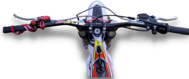
Una vez instalado el manillar, colocar el cable de gas y el latiguillo embrague, según la fotografía. Una vez este montado, girar el manillar a ambos lados, para comprobar que no se enganchan estos, y también comprobar que el acelerador vuelve con normalidad.
