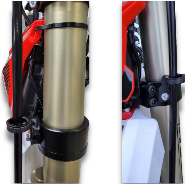
Colocar el latiguillo delantero, dentro de la guía original del foco.
