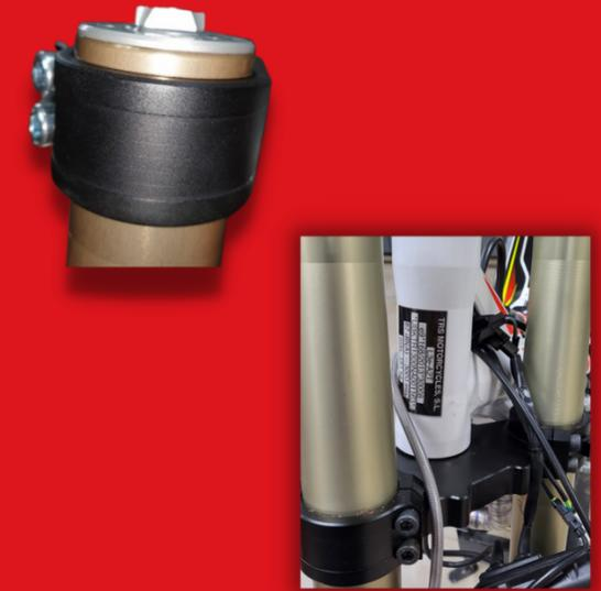
Montar las dos barras horquilla, y engrasar en la primera línea de la botella con la tija superior. Engrasar y dar apriete a los tornillos M8 (ALLEN de 6) que sujetan las barras con la tija inferior (2 kgf-m).
