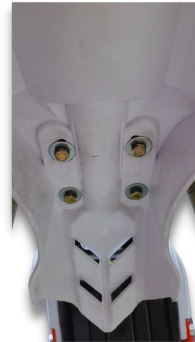
Fijar el guardabarros en la tija inferior, juntamente con el soporte rojo y los 4 casquillos, con 4 tornillos M6 y un par de apriete de 1,0 kgf-m.
