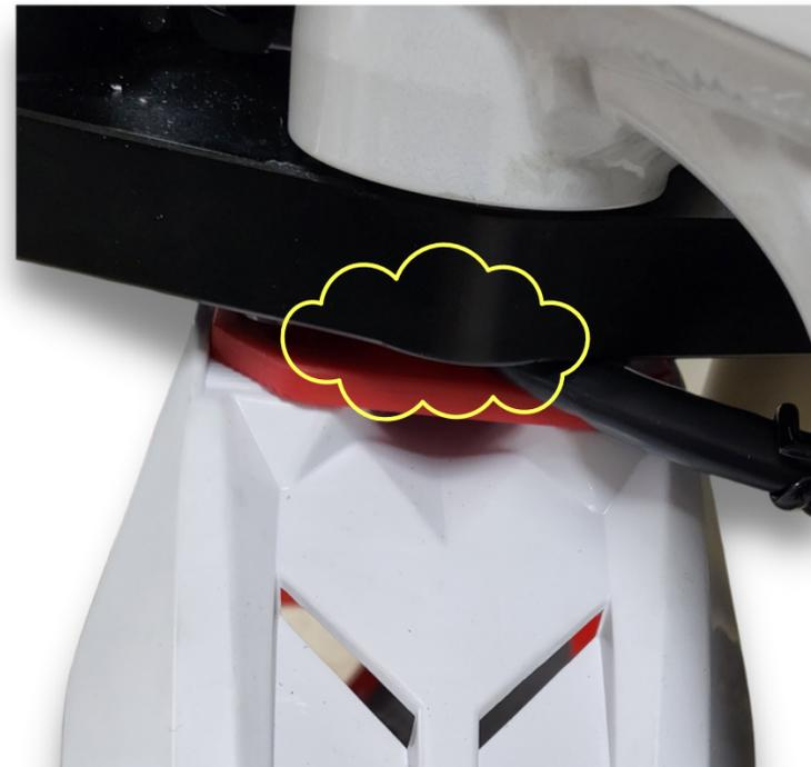
Pasar los cables, como se aprecia en la fotografía, entre el soporte rojo y la tija inferior.
