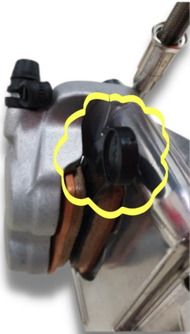
Extraer las dos pestañas plástico de seguridad de la pinza delantera.
