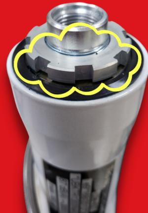
Colocar la tija inferior en la pipa del bastidor. Enroscar la tuerca indicada de ajuste y dar un apriete de 0,5 kgf-m. Es importante engrasar el cojinete superior e inferior.
