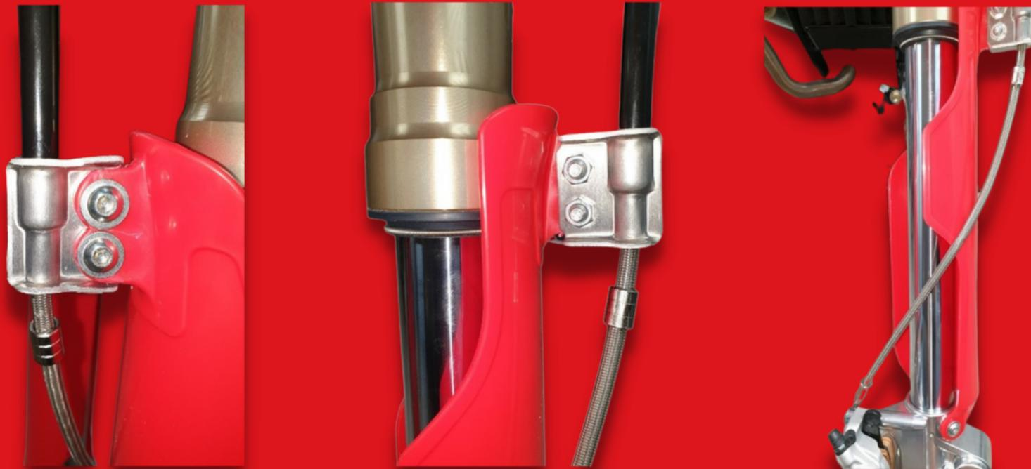
Colocaremos el soporte latiguillo al protector de horquilla (las dos piezas van por la parte interior), primero la que no lleva tuercas de ajuste. Par apriete de los tornillos M6 de 1 kgf-m (ALLEN de 4).
