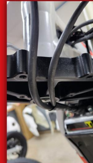
Colocaremos por debajo la tija inferior la instalación eléctrica, como en la de serie. Colocaremos la tija superior en la pipa del bastidor. Enroscar la tuerca superior hasta ajuste.
